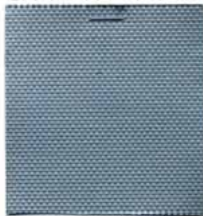
ガラスシートSG2000使用 難燃性試験C種合格
